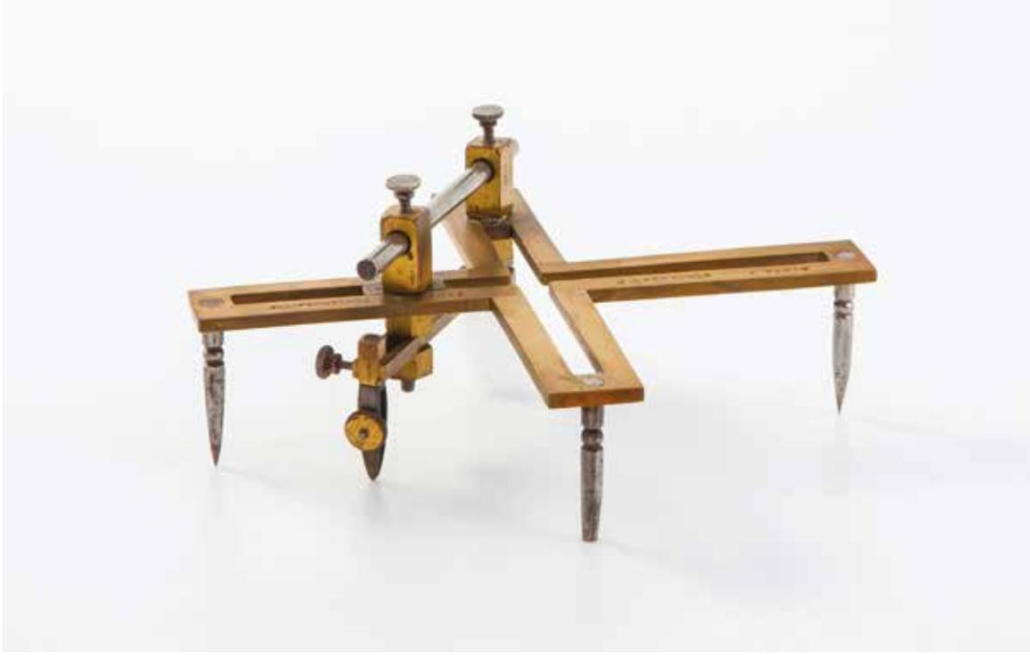
L'ellipsographe est un instrument utilisé pour dessiner des ellipses : des courbes planes fermées.
