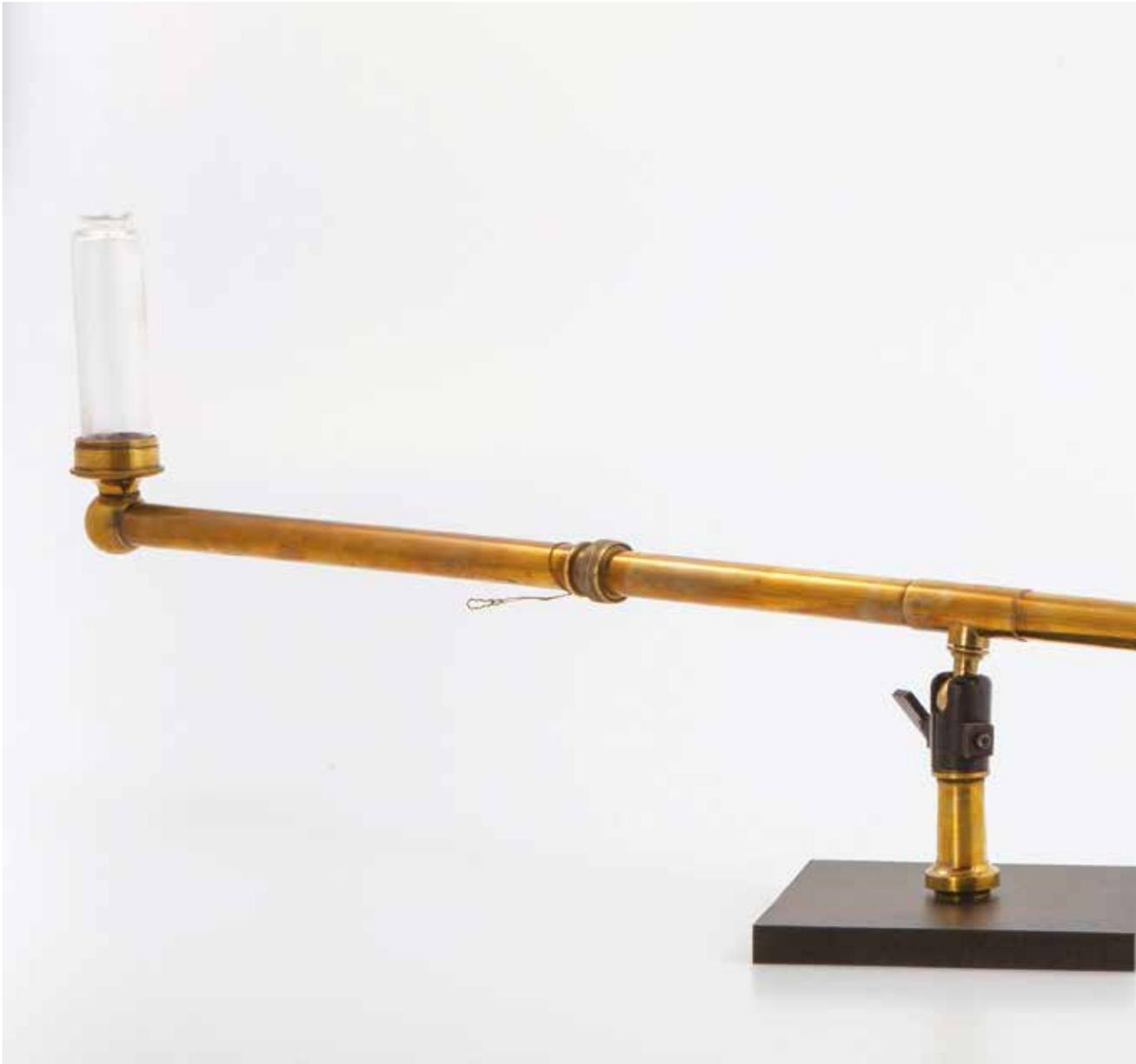
Le fonctionnement de ce niveau à eau est fondé sur le principe des vases communicants. La visée se fait à travers le niveau d'eau sur les deux fioles pour obtenir une ligne horizontale.
