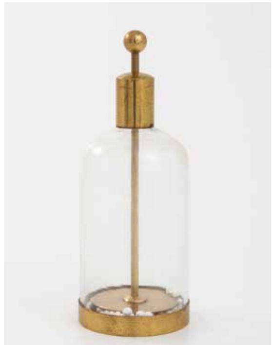
La bouteille à grêle de Volta permet de faire la démonstration de phénomènes d'électricité statique. Une fois le plateau métallique contenu dans la bouteille chargé électriquement, de petites boules de sureau sont alternativement attirées par le plateau puis rejetées dans le fond de la bouteille.
