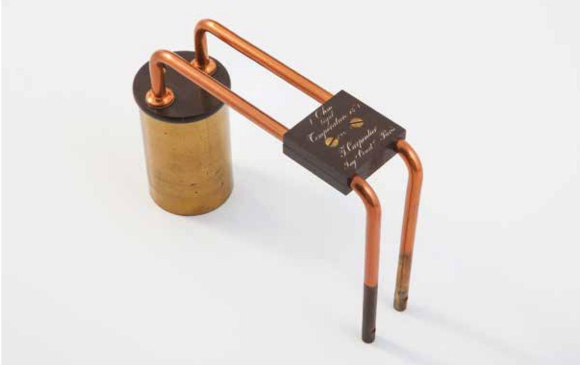
L'Ohm légal est une résistance étalon de haute précision pour des mesures en laboratoire et pour étalonner des instruments de mesures électriques.
