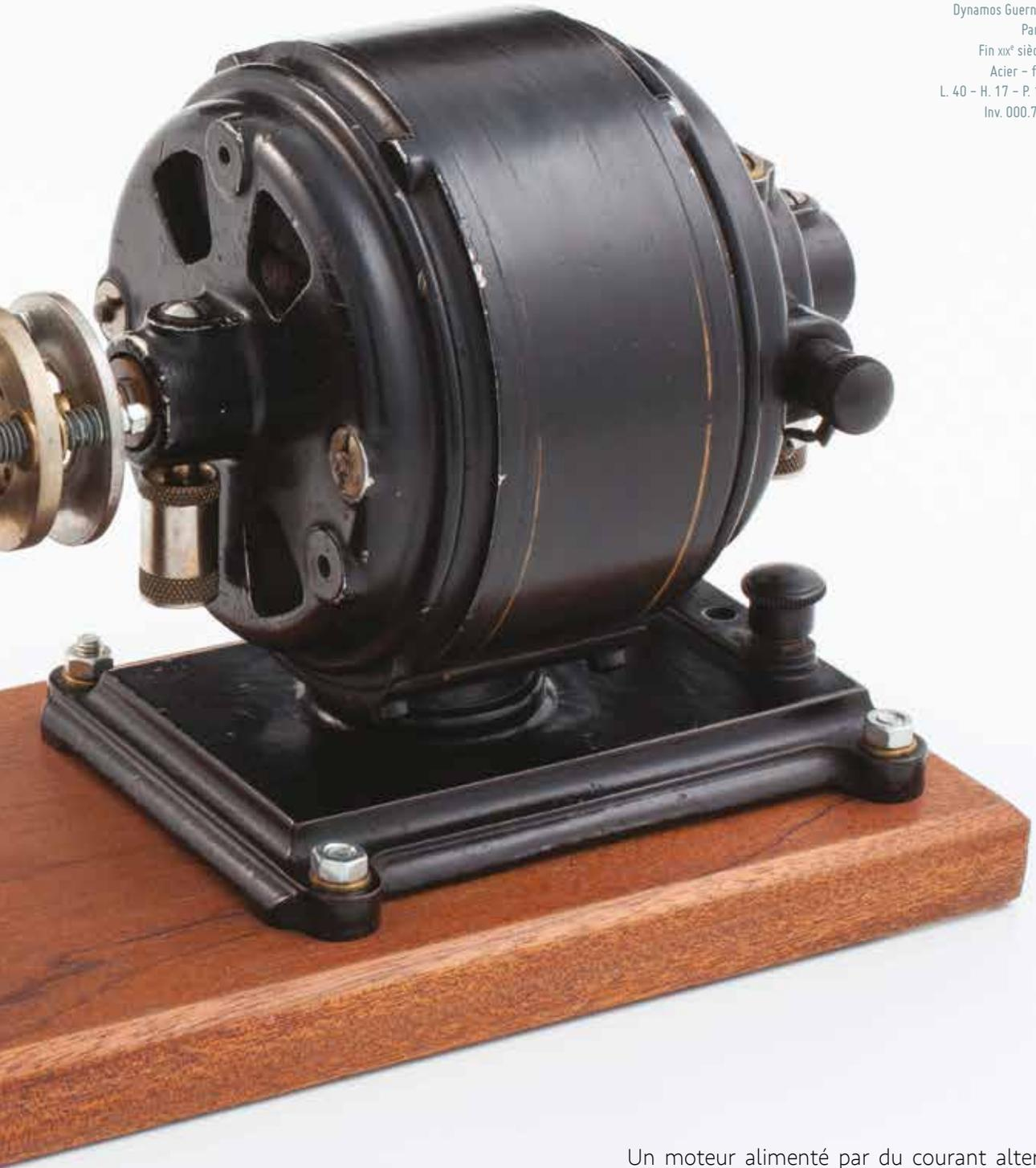
Un moteur alimenté par du courant alternatif (110V) est accouplé à une dynamo qui produit du courant continu (5/7 V et env. 6 A). Cette association est souvent utilisée dans des procédés industriels qui fonctionnent sous courant continu.
