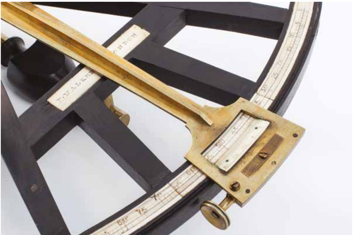
1 En pleine mer, les marins se repèrent en s'appuyant sur l'observation de la voûte céleste : ils mesurent la hauteur du soleil, des étoiles ou des planètes par rapport à l'horizon, afin de déterminer la position du bateau. L'octant qui a une ouverture angulaire de  $45^\circ$ , permet d'effectuer ces mesures.
