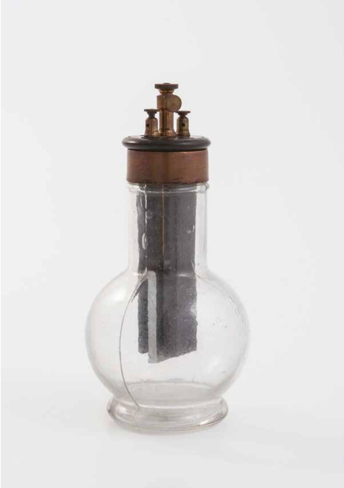
La pile de Grenet permet de convertir de l'énergie chimique en énergie électrique. Elle délivre une intensité quasiment constante durant plusieurs heures.
