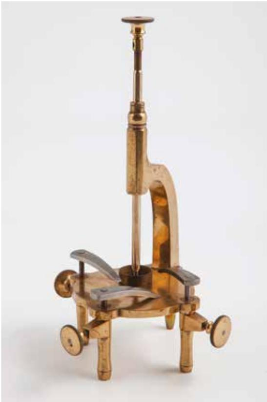
Le perce-droit positionne les trous sur une platine, parallèlement à une seconde platine.
