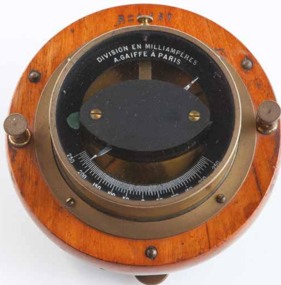
1 Ce galvanomètre de ligne à aimant mobile permet de déterminer le sens de circulation et la valeur de l'intensité d'un courant en milliampère. Il comporte une aiguille aimantée, qui est orientée vers le Nord par la rotation du boîtier cylindrique sur son socle en bois pour assurer la mise à 0.
