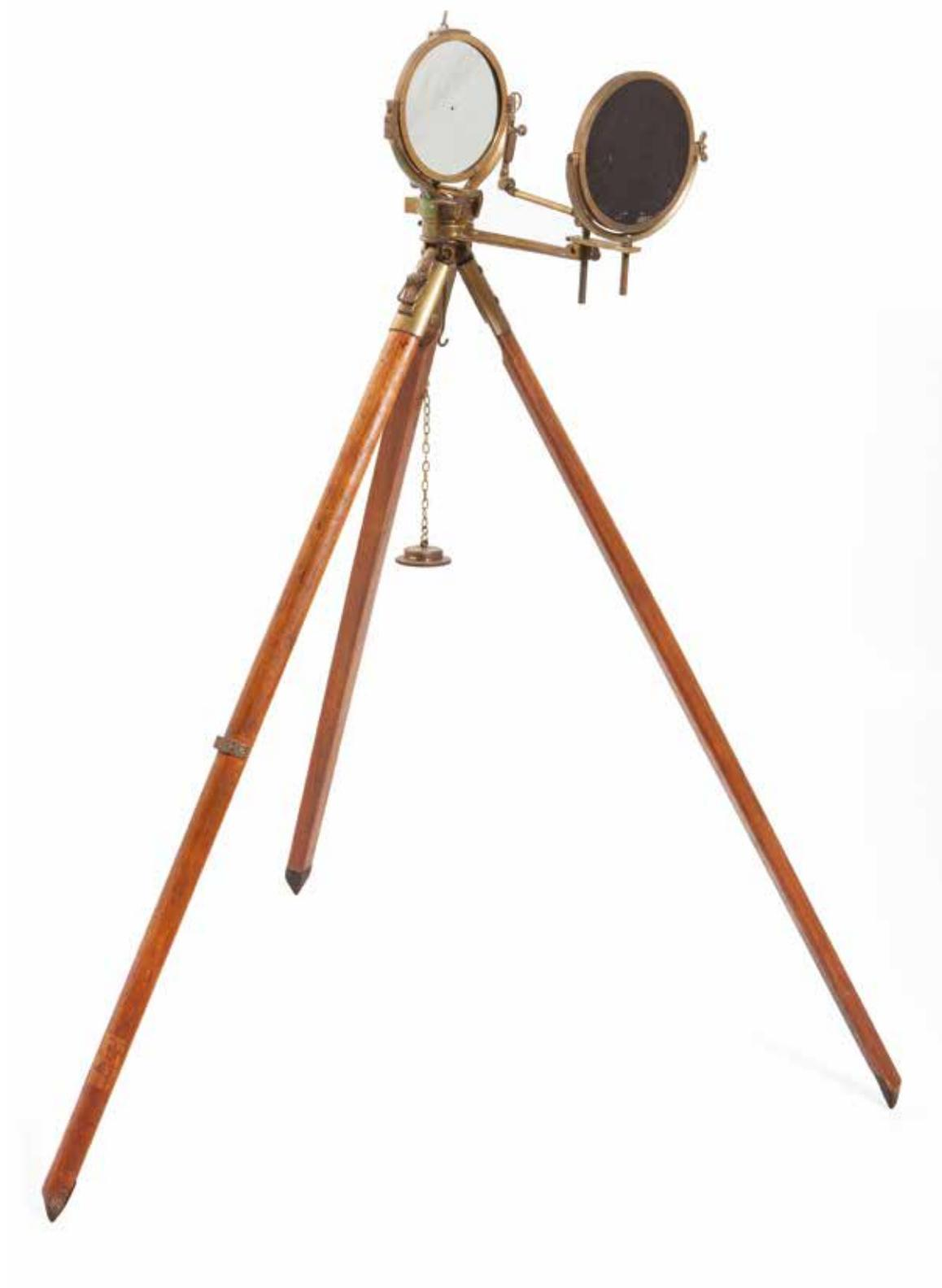
L'héliographe est un système de télégraphie optique utilisant le soleil comme source de lumière. Les deux miroirs orientables captent la lumière du soleil et la renvoient vers la station de réception. Léger, facilement transportable et perceptible de loin, cet instrument a principalement été utilisé sur le terrain par les militaires.
