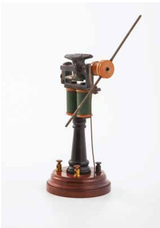
Moteur électrique pour tube de Geissler
