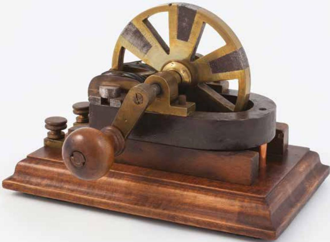
Le sonneur est constitué d'une roue en laiton dans laquelle sont régulièrement encastrées des pièces de fer doux. La roue est actionnée par une manivelle et passe au centre d'un aimant formant un fer à cheval et produisant un champ magnétique. Sur les pôles de l'aimant sont fixées des bobines. Le passage des pièces de fer provoquent un déplacement des lignes de force du champ magnétique et induisent ainsi un courant dans les deux bobines.
