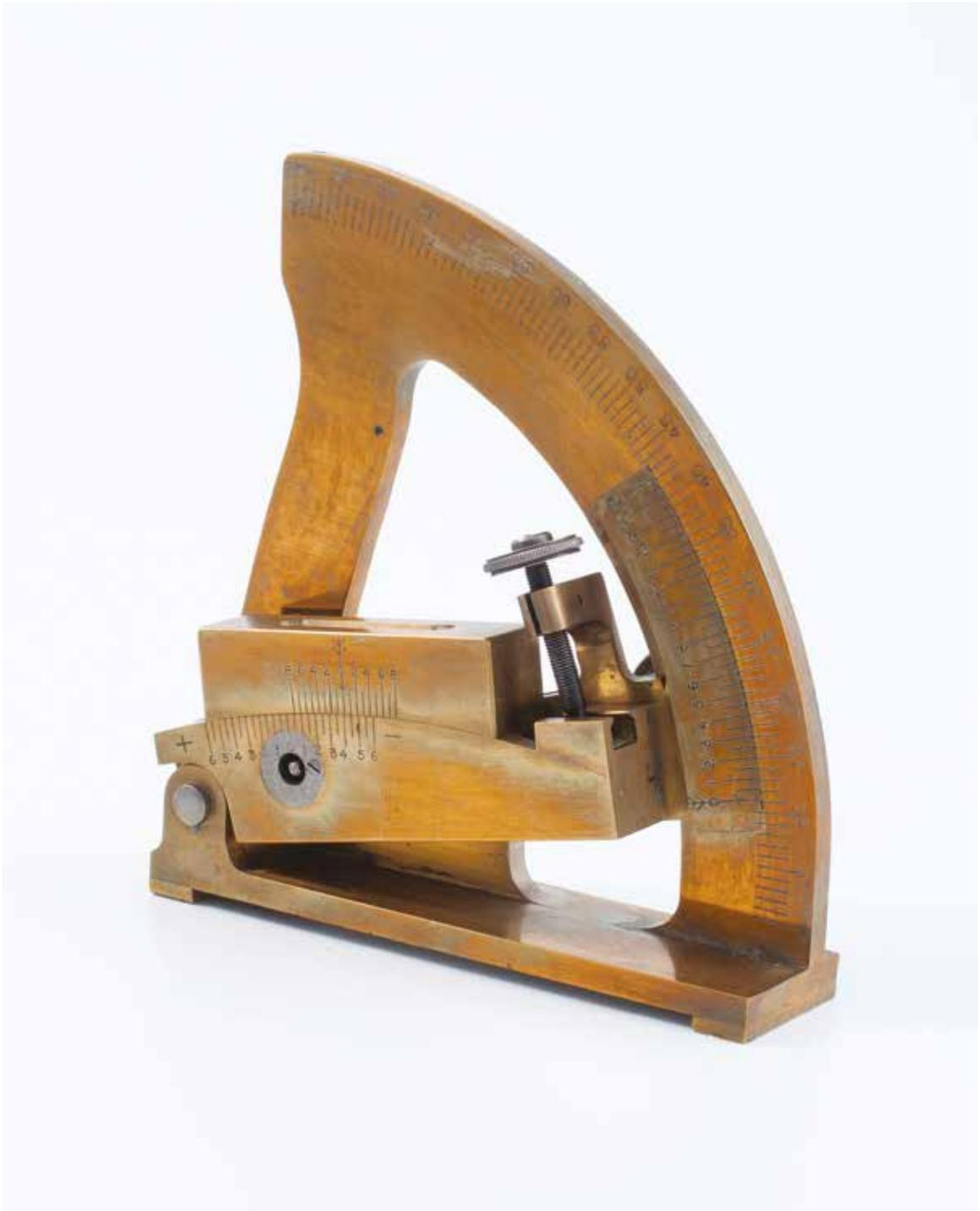
Cet instrument permet de régler la hausse d'une grande pièce d'artillerie.
