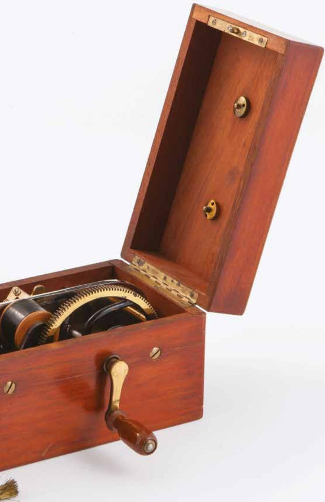
Ce métronome associé à un interrupteur à bain de mercure, a été utilisé en électrothérapie pour cadencer les chocs électriques.
