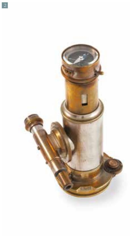
Niveau à collimateur avec boussole et lunette de visée
