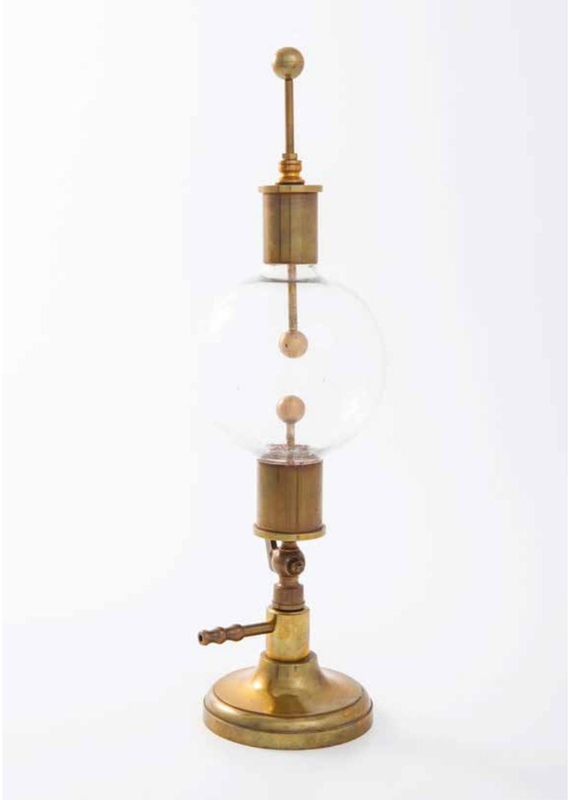
Cet appareil sert à produire et observer les effets lumineux des décharges électriques dans des gaz et sous diverses pressions atmosphériques. Sous air raréfié, l'étincelle observée prend la forme d'une gerbe ramifiée.
