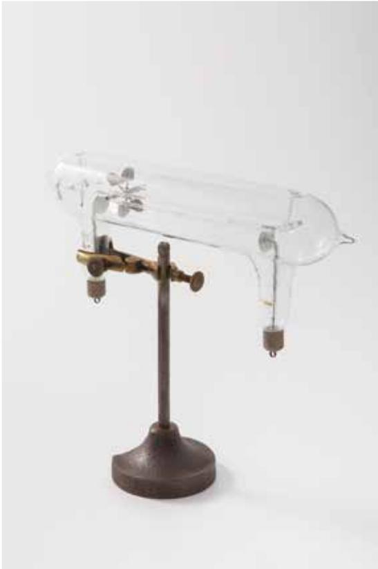
Relié à une bobine de Ruhmkorff, le tube de Crookes permet d'observer des faisceaux d'électrons imperceptibles à l'œil nu. En passant dans le tube, les électrons viennent percuter les palettes d'un moulinet, le faisant tourner et se déplacer sur le rail sur lequel il a été disposé.
