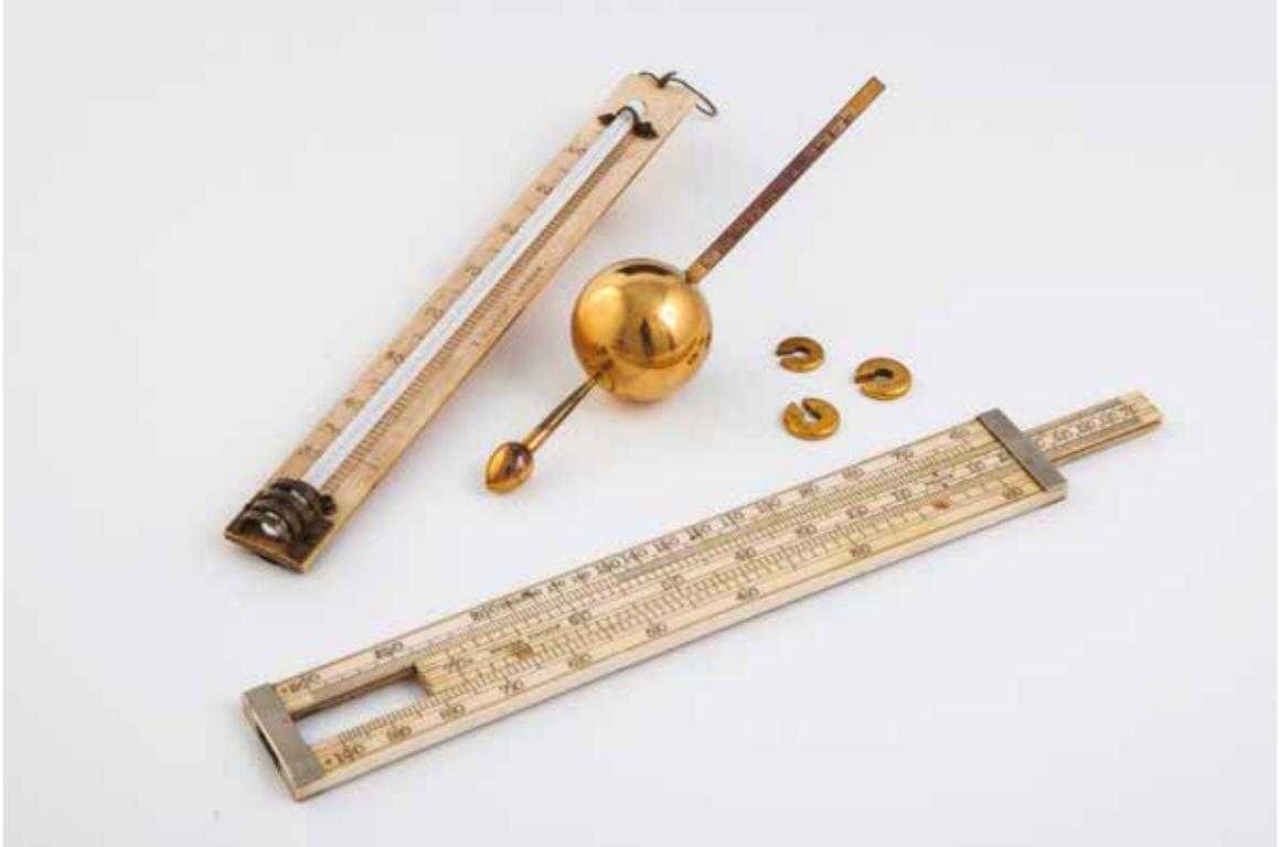
L'aréomètre de Sikes est un instrument de vérification de la teneur en alcool des boissons pour les transactions commerciales. Des charges, sous forme de disques échancrés, peuvent être placées au-dessus de la sphère inférieure de l'instrument. Elles modifient ainsi son poids et sa position d'équilibre à l'immersion, afin de couvrir une plus large échelle de concentrations alcooliques.
